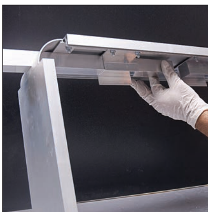
Fissaggio tubo quadri 30x30 per staffa
